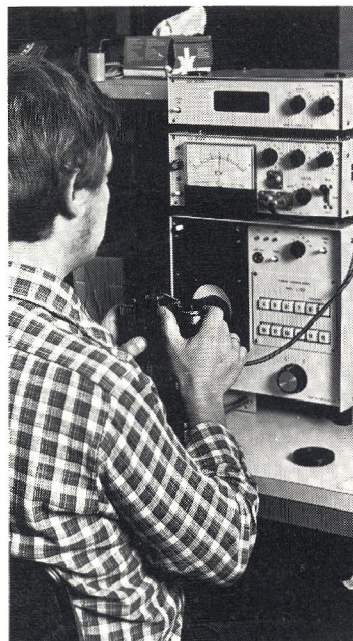
På dette testudstyr kontrolleres lysmåler og eksponeringsteknik.
